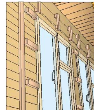
Рис. 18. Устройство обрешетки вокруг проемов
