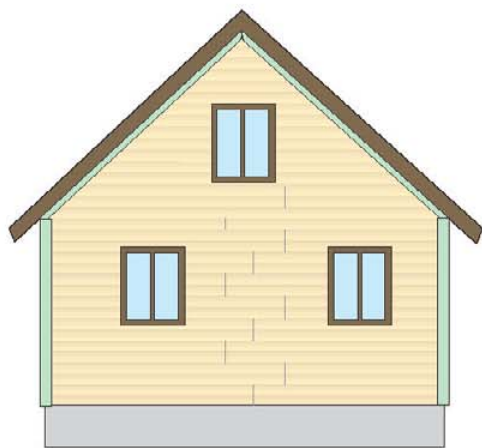
Рис. 45. Смещение «нахлестов» на сайдинговой обшивке
